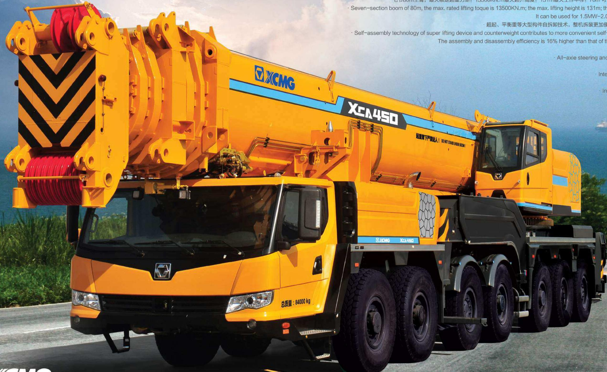
· 七节80m主臂，最大额定起重力矩：13500KN.m最大起升高度：131m最大工作半径：70m 可用于1.5MW–2.0MW风电维修；
