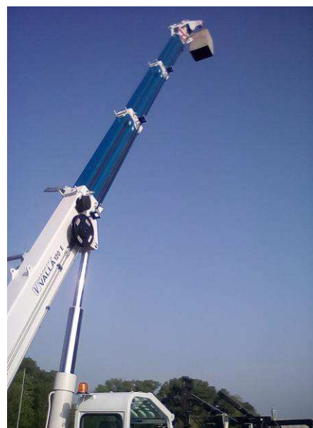
Braccio telescopico in grado di raggiungere altezze fino a 10 metri
