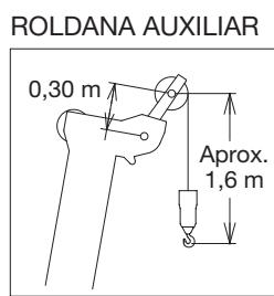
A altura de elevação e ângulo da lança acima são baseados em uma lança reta (sem carga) e equipamento nivelado em uma superfície firme. Devem ser considerados a deflexão da lança e a subsequente mudança no raio obtida sob condições de carga.
