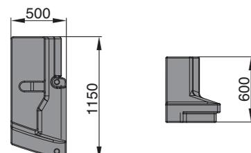
When using H2, counterweight ⑦ is not applicable · Wenn H2 verwendet wird, entfällt Gegengewicht ⑦ · Avec H2, contrepoids ⑦ non compatible · H2 è incompatibile con il contrappeso ⑦ · Al usar H2 no es aplicable el contrapeso ⑦ · Usando o H2, o contrapeso ⑦ não se aplica · При использовании H2 противовес ⑦ не применяется
