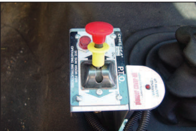
5. Disengage the PTO.
