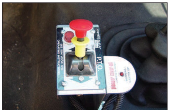
6. Disengage the PTO.
