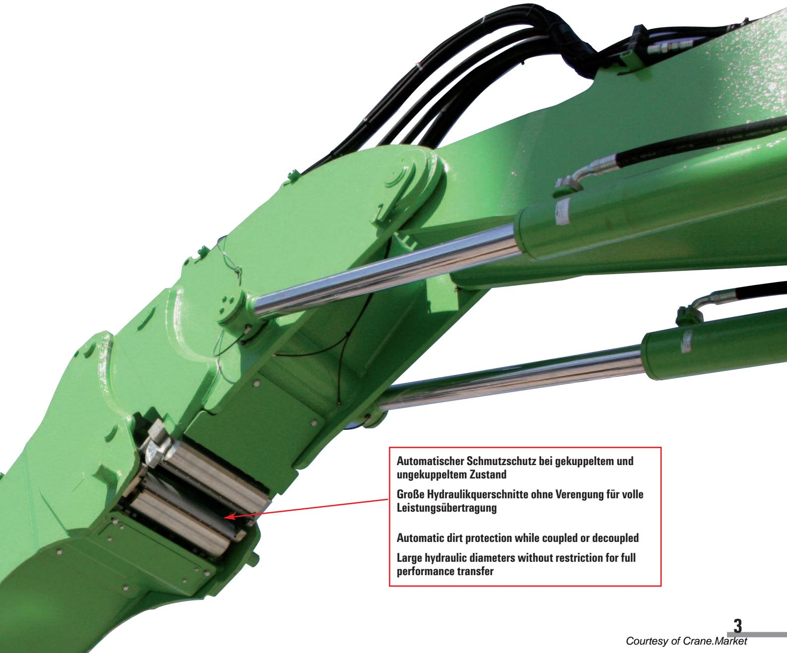
Automatischer Schmutzschutz bei gekuppeltem und ungekuppeltem Zustand
