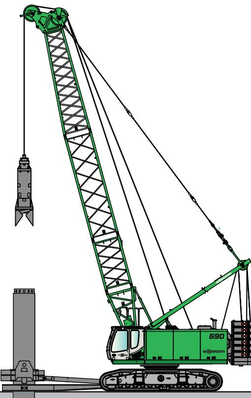
**Verrohrungsmaschine - casing oscillator**
