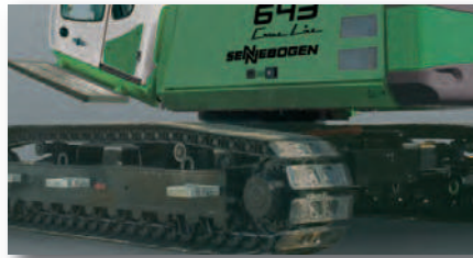
Unterwagen - hydraulisch teleskopierbar, sehr robuste Konstruktion mit sehr starkem Laufwerk - optional Flachbodenplatten Undercarriage - hydraulically extendable, very robust duty cycle design with extra strong crawlers - optional flat shoes
