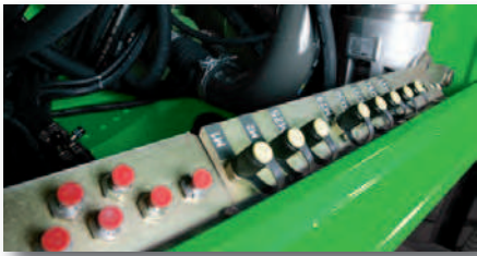
Zentrale Messpunkte zur einfachen und schnellen Überprüfung der gesamten Hydraulikanlage Central measuring points for simple and quick inspection of the entire hydraulic system
