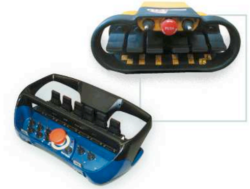
Scanreco/Hetronic multifunction radio control. Radiocontrol multifunción de serie Scanreco/Hetronic.
