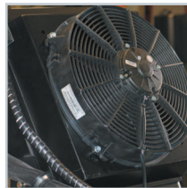
Heat exchanger. Cambiador de calor.
