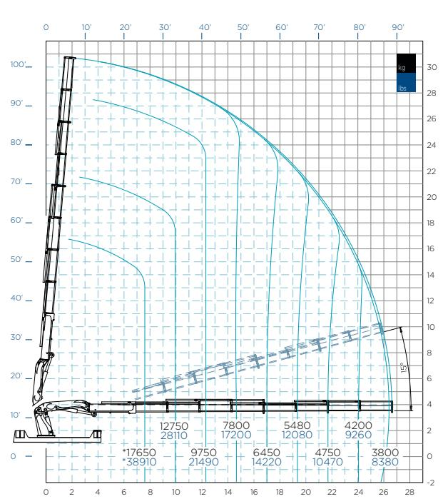
\*\*\*Portata massima passante per l'orizzontale. Le prestazioni indicate si ottengono con angolo di targa pari a 20°.
