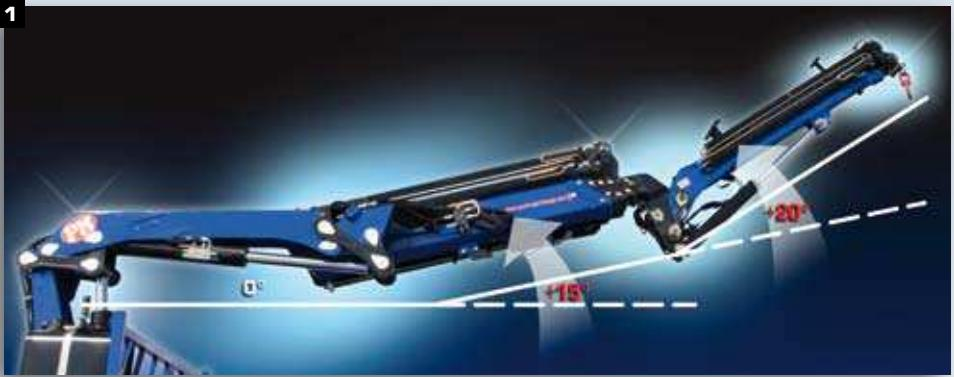
**1** Braccio secondario con extra corsa negativa di 15° e Antenne con angolo negativo di 20°, che minimizzano le flessioni degli sfili idraulici, garantendo un perfetto controllo del carico, in ogni posizione di lavoro.
