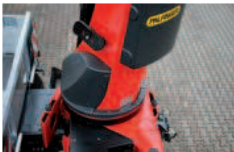
ENDLOSSCHWENKWERK UNEINGESCHRÄNKTE BEWEGUNG
