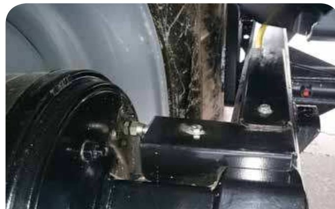
Hamulce: pneumatyczne lub hydrauliczne, z cylindrem wewnętrznym lub zewnętrznym
