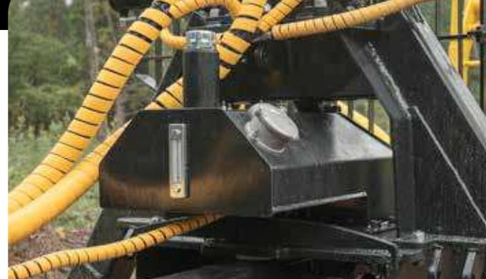
Zbiornik na olej hydrauliczny montowany pod konsolą żurawia
