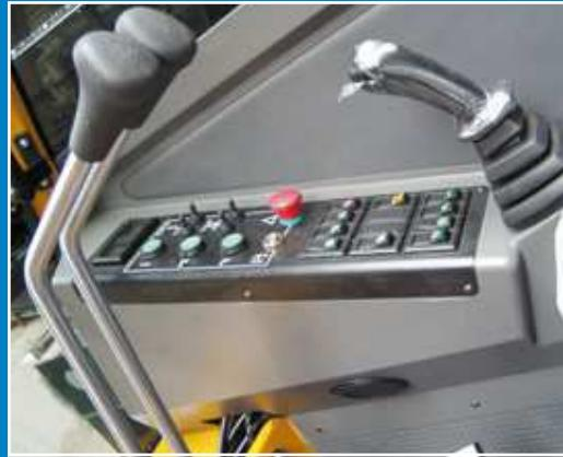
Comandi gru ottenuti tramite due manipolatori ergonomici integrati nei braccioli. Due leve-pedale sono utilizzate per la traslazione.
