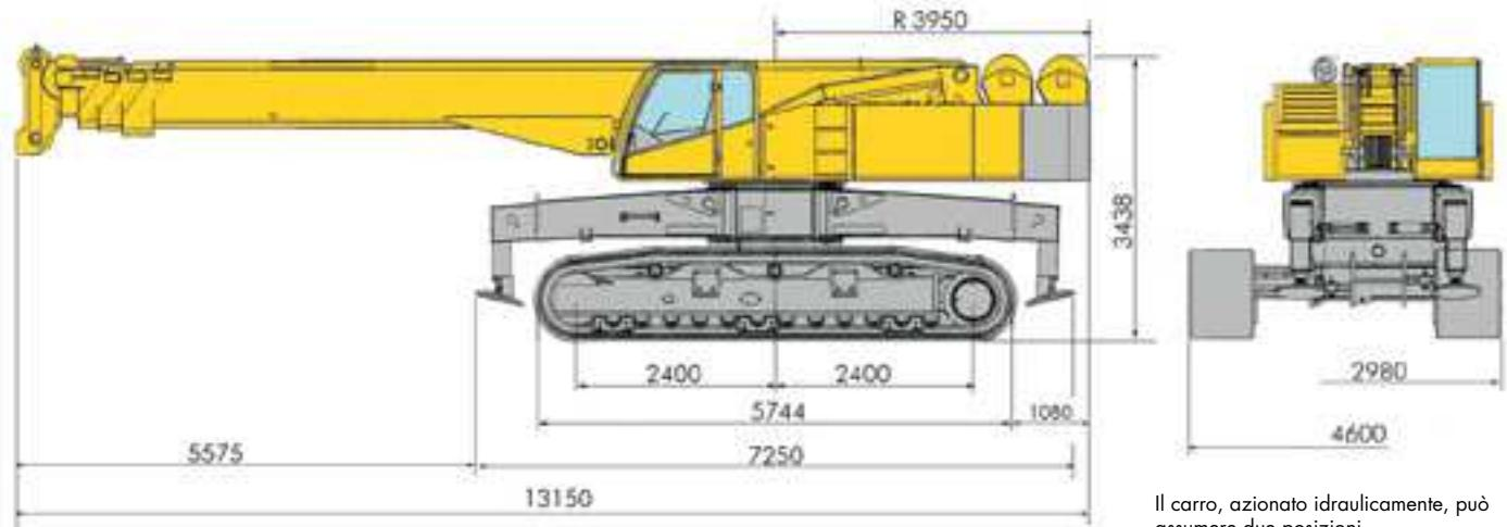
Il carro, azionato idraulicamente, può assumere due posizioni.
