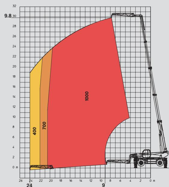
ROTATION SUR STABILISATEURS DÉPLOYÉS AVEC POTENCE PT 800 TÉLESCOPÉE
