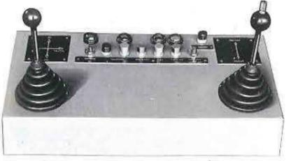
Vom Steuerpult aus werden alle Kranbewegungen geschaltet. Die Schaltung der einzelnen Bewegungen in beiden Richtungen in sieben lastunabhängigen Geschwindigkeiten ist nahezu stufenlos möglich. Der im linken Steuerhebel eingebaute Totmannkopf muß bei allen Kranbewegungen betätigt werden. Beim Loslassen desselben werden sämtliche Kranbewegungen stillgelegt.
