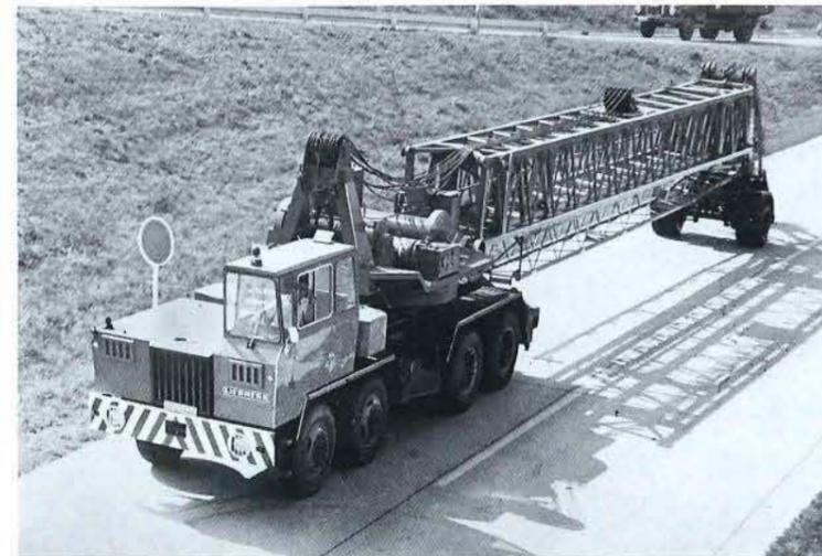
In Turmdrehkranausführung werden zum Straßentransport Turm und Ausleger auf eine Nachlaufachse abgelassen, wobei eine zulässige Länge von 25 m nicht überschritten wird. Der Nachläufer kann in engen Kurven von Hand nachgelegt werden. Auch in dieser Ausführung wird eine Geschwindigkeit von 55 km/h erreicht.
