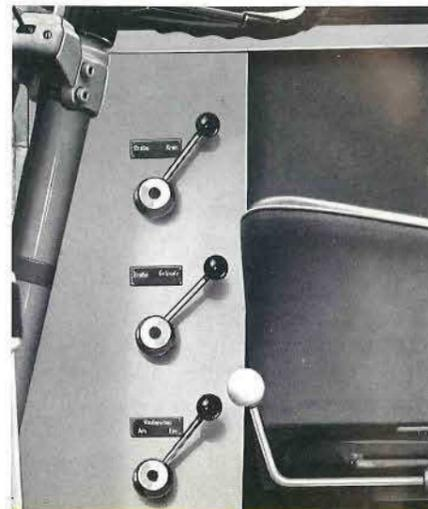
Vom Fahrersitz aus können alle Schaltungen für die einzelnen Antriebe leicht und übersichtlich ausgeführt werden. Eine Kontrolllampe auf dem Armaturenbrett zeigt jeweils an ob das Aggregat eingeschaltet ist.
