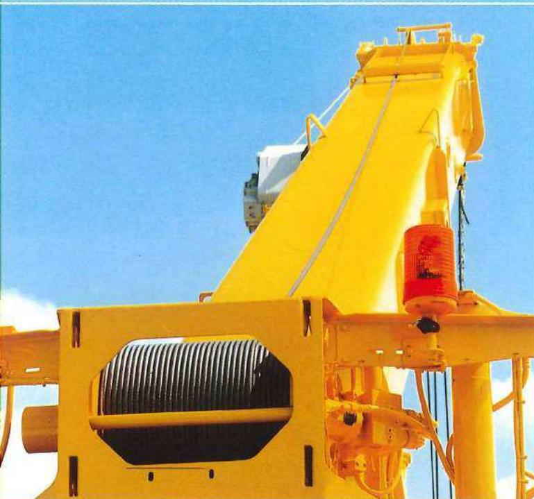
Von einem Hubwerk erwarten Sie Schnelligkeit und Feinfühligkeit sowohl beim Heben als auch beim Senken. Dieses Hubwerk mit seinem robusten, innenliegenden Planetengetriebe und der sicheren Haltebremse leistet beides. Das verdreharme Hubseil spult in jeder Lage präzise und mit der elektronischen Windendrehanzeige können Sie zentimetergenau heben und senken. Dank der „Load-Sensing“-Steuerung können bis zu vier Bewegungen gleichzeitig gefahren werden.
