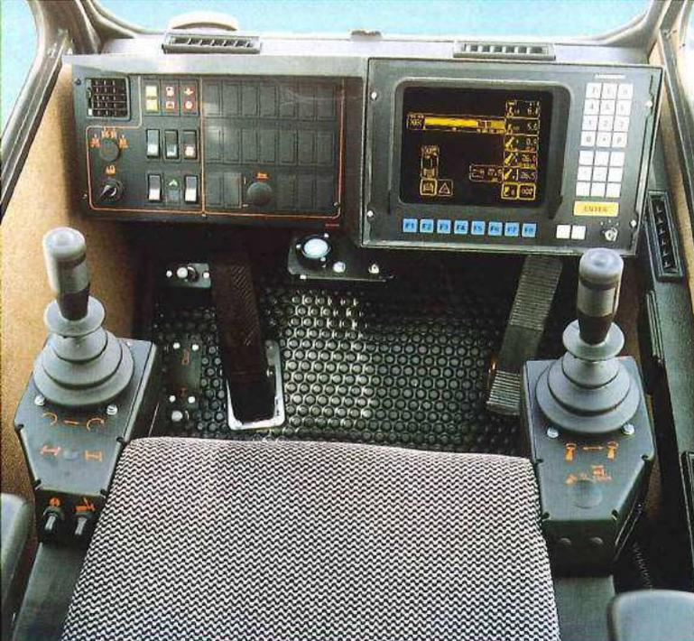
In dieser Krankabine kann sich der Fahrer wohl fühlen. Die Bedienelemente sind übersichtlich und ergonomisch angeordnet, das verbessert die Arbeitsqualität und erhöht die Sicherheit. Die Seitenscheiben sind getönt und auch das Sonnenschutzrollo gehört zum Standard. Mit den verstellbaren Steuerhebelkonsolen und der Lendenwirbelstütze im Kransitz findet jeder seine Einstellung nach Maß. Mehr Komfort bedeutet mehr Konzentration, und damit auch eine verbesserte Leistung.
