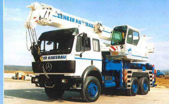
Teleskopkran LTF 1030-3 mit 3achsigem Daimler-Benz-Fahrgestell Typ 2631 K / 6 x 4.
