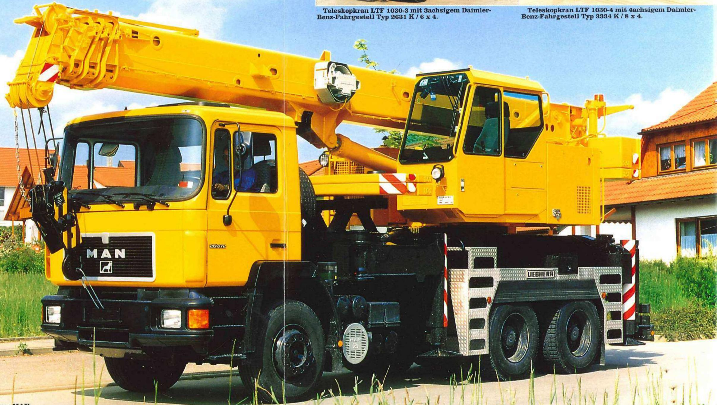
Teleskopkran LTF 1030-3 mit 3achsigem MAN-Fahrgestell Typ F 09 26/27.372 DF 6 x 4.
