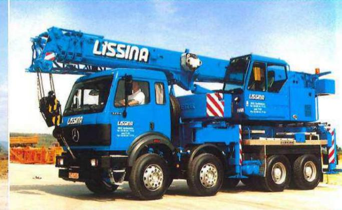
Teleskopkran LTF 1030-4 mit 4achsigem Daimler-Benz-Fahrgestell Typ 3334 K / 8 x 4.
