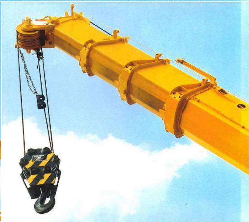
Der 4teilige, bis 26 m lange Teleskopausleger ist im Untergurt 4fach gekantet und damit besonders beul- und verwindungssteif. Tausendfach hat sich das hydromechanische Teleskopiersystem bewährt. Der 2fach-Flaschenzug für die 3. und 4. Auslegerstufe wirkt sich bei niedrigem Auslegerschwerpunkt traglaststeigernd aus. Die LICCON-Anlage erfasst die Durchbiegung des Teleskopauslegers unter Last und errechnet für jede beliebige Auslegerlänge die bestmögliche Traglast.
