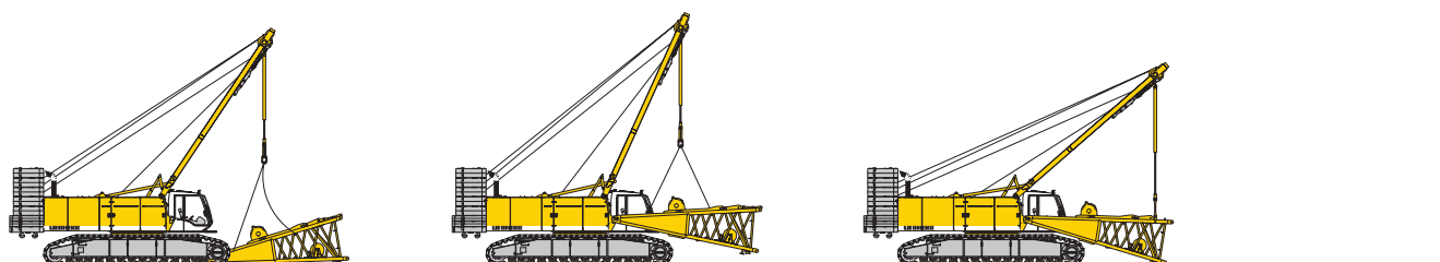
Entladung und Anbau des Auslegerlenkstücks
