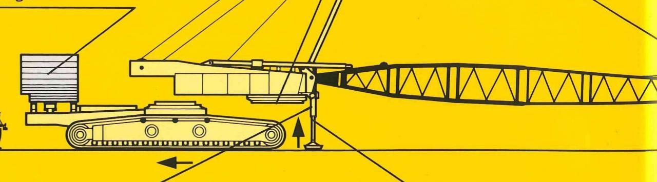
**2** Dann wird das Auslegersystem abgelegt und die 2 Hydraulikzylinder für die Selbstmontage an der Drehbühne angebaut.
