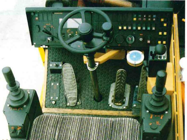
Geräuschisolierte Großraum-Krankabine mit Komfort-Armlehnensteuerung, standardisierten Bedien- und Kontrollinstrumenten für Kranfahren, Abstützen und „Verfahren von oben“ und die elektronische LMB mit Diagnoseprogramm sind perfekte Details für den sicheren und reibungslosen Kranbetrieb.
