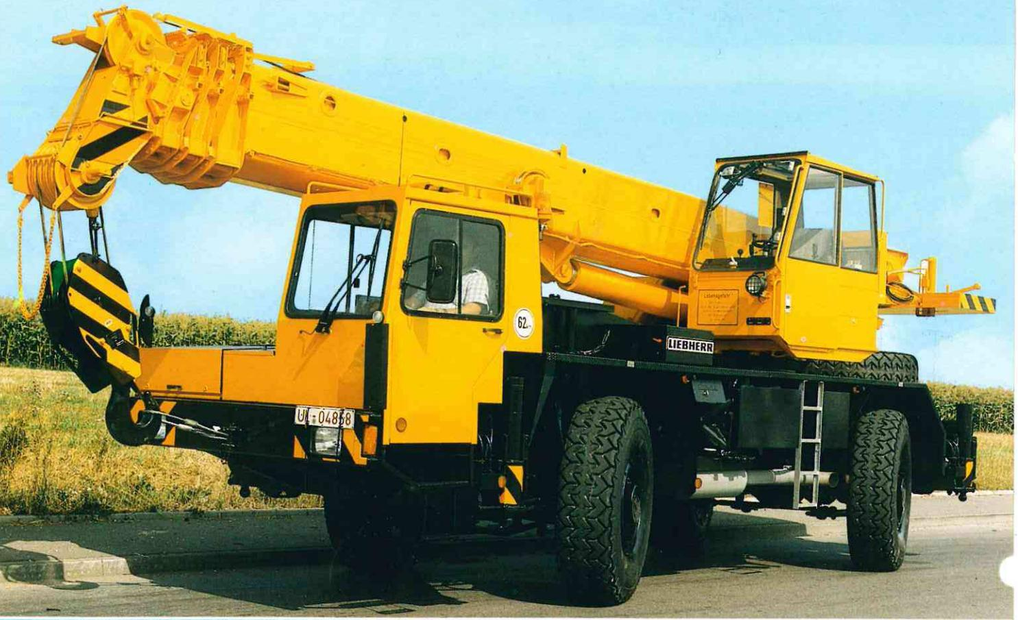
Mit dem variablen Ballast bleibt auch der LTM 1035-2 mit 2-Achs-Fahrgestell und Teilballast unter 24 t Gesamtgewicht. Die Ausstattung reicht für diesen 2-Achser vom Allradantrieb und der Allradlenkung, der Niveaumatik-Federung mit Programmsteuerung und der
