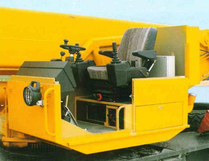
Mit einer Durchfahrthöhe von 2,95 m ist der LTM 1035 der niedrigste Mobilkran in seiner Klasse. Erreicht wird dieses Maß mit der Standardbereifung, der Niveaumatik-Federung zum Absenken des Fahrzeugs und der Vario-Krankabine mit abnehmbarem Oberteil.
