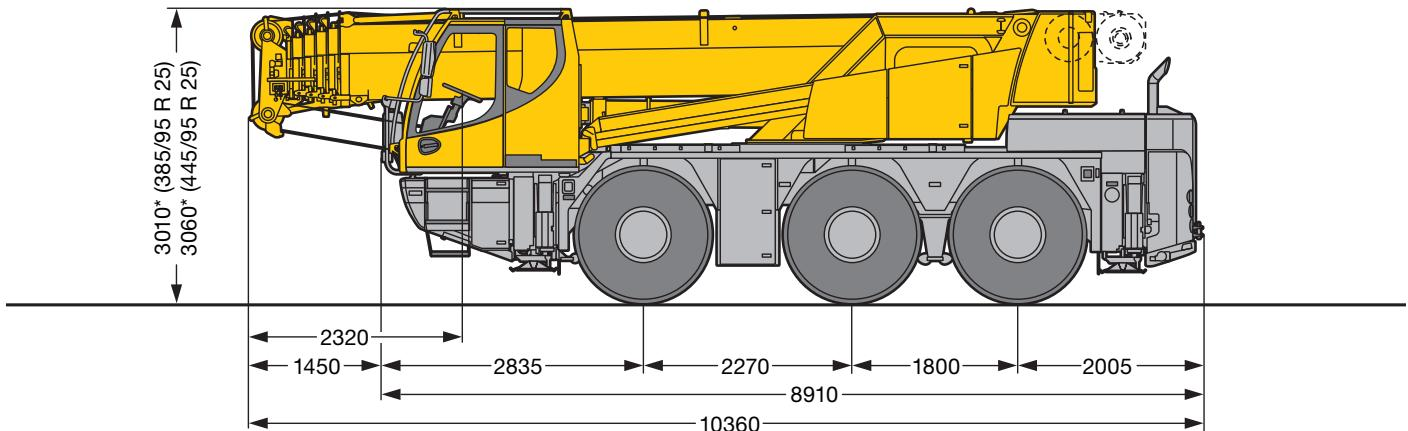
\*100 mm abgesenkt · lowered · abaissé · abbassato · suspensión abajo · шасси осажено
