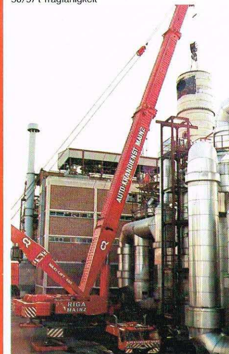
GOTTWALD AMK 400-93, 400/500 t Tragfähigkeit
