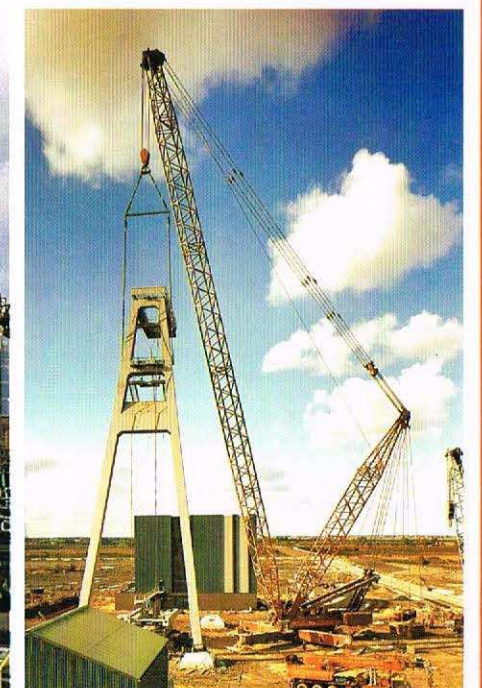
GOTTWALD AK 680, 650/850 t Tragfähigkeit
