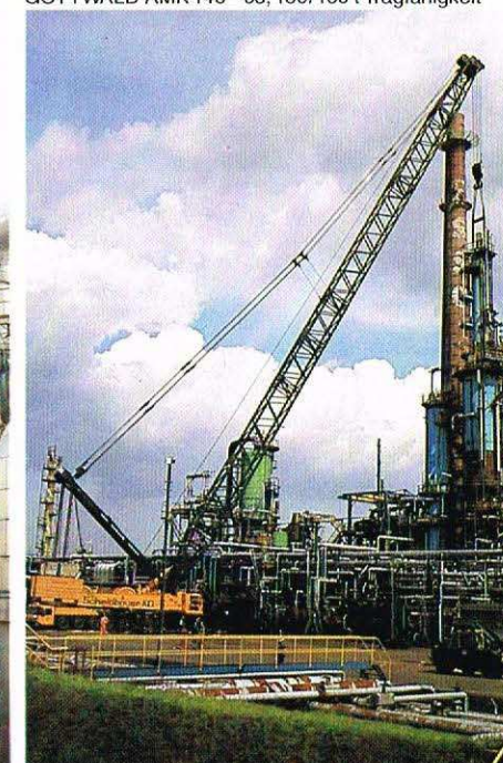
GOTTWALD AK 850, 800/850 t Tragfähigkeit
