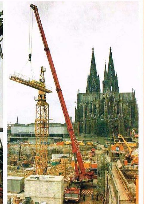
GOTTWALD AMK 200-83, 200/230 t Tragfähigkeit
