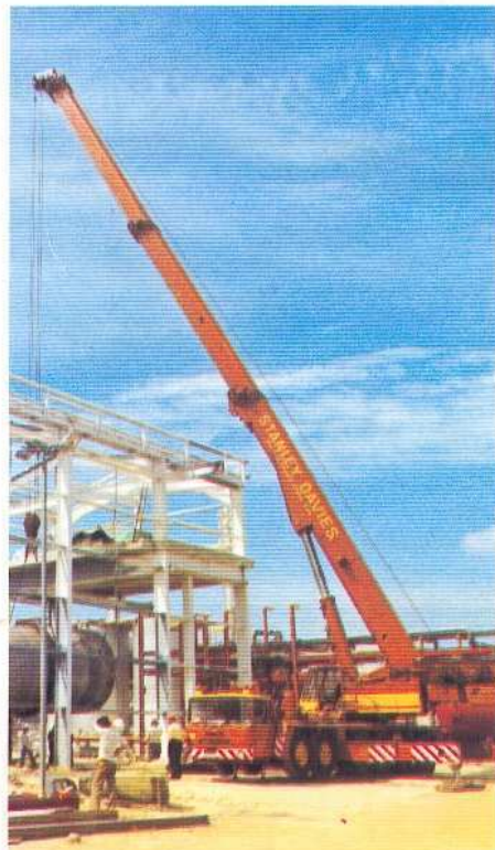
GOTTWALD AMK 200-103 mit 200/230 t Tragfähigkeit
