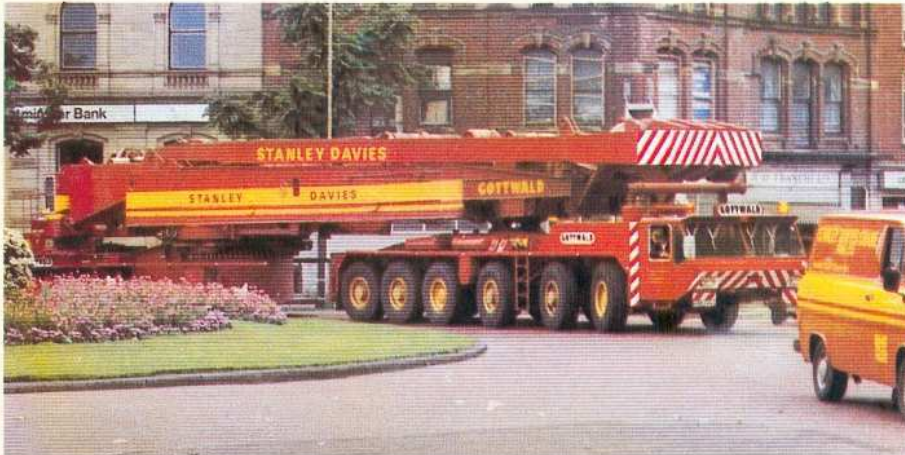
GOTTWALD AK 680 mit 650/850 t Tragfähigkeit
