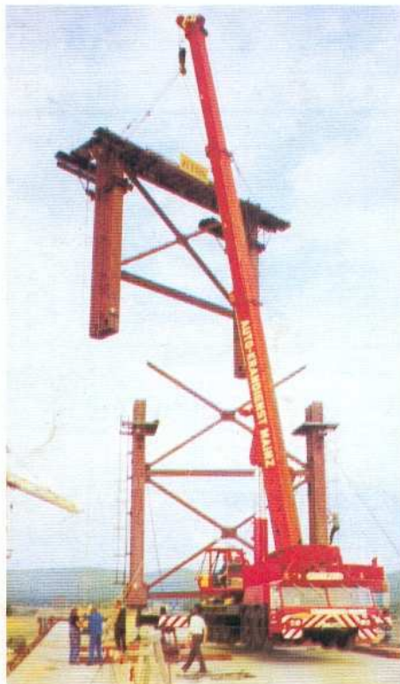
GOTTWALD AMK 126-63 mit 125/142 t Tragfähigkeit
