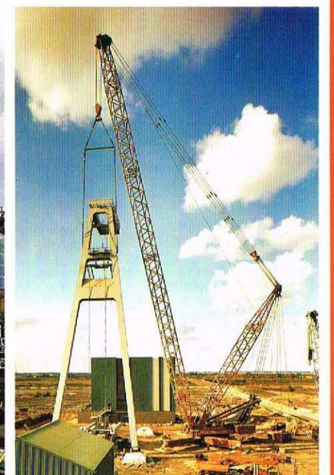
GOTTWALD AK 680, 650/850 t Tragfähigkeit
