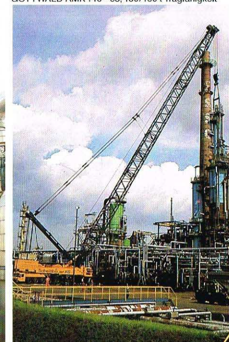
GOTTWALD AK 850, 800/850 t Tragfähigkeit
