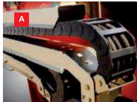
**ES A** Tuberías adicionales° para el uso de accesorios hidráulicos, en grúas y en extensiones hidráulicas, protegidas por un sistema Fassi exclusivo constituido por canaletas metálicas combinadas con cadenas de nailon de alta resistencia.
